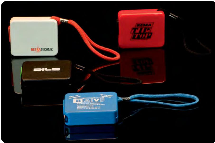
Mètre à ruban à forme classique avec touche d'arrêt et retour automatique du ruban. Boîtier en plastique ABS résistant aux chocs. Ruban en acier trempé, laqué blanc, graduation bicolore en noir et rouge résistant à l'usure grâce à un vernis protecteur. Couleur standard: Translucides bleu, rouge, vert, jaune, orange et noir, blanc. Couleur touche d'arrêt: blanc, noir, rouge, bleu, vert, orange, jaune. Garantie\* 3 ans. Fabriqué en Allemagne.
